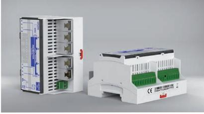
MOBOTIXの新しいMxSwitchは、最大4つのMOBOTIXドアステーション、カメラ、あるいは他のPoE/PoE+のデバイスに直接接続し、電源を供給することができるコンパクトなDINレール・モジュールです。合計最大75WアウトプットとPoE電源なしのアップリンクポートで4つのPoE+ポートに加え、完全なMOBOTIXドアステーションを非常に簡単に接続し電源供給する更なる技術的特徴を持っています。
